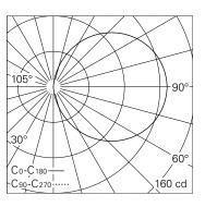
LED 3000 K 4.9 W 370 lm-h / CIE Flux 13 37 66 50 100 / C11 nach DIN 5040
