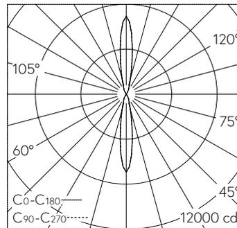
LED 3000 K 27 W 2216 lm-h / CIE Flux 99 100 100 50 100 / C84 nach DIN 5040
