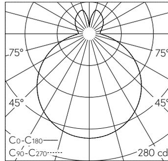
LED 3000 K 10 W 957 lm-h / CIE Flux 43 73 91 77 100 / B32 nach DIN 5040
