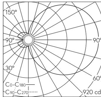
LED 4000 K 35 W 3400 lm-h / CIE Flux 17 41 69 50 100 / C11 nach DIN 5040
