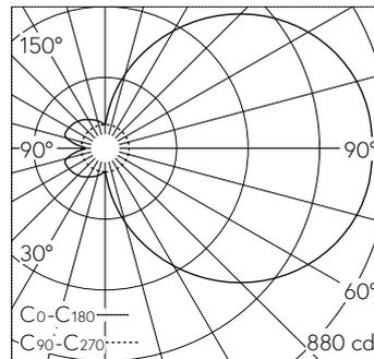
LED 3000 K 35 W 3343 lm-h / CIE Flux 17 41 69 50 100 / C11 nach DIN 5040
