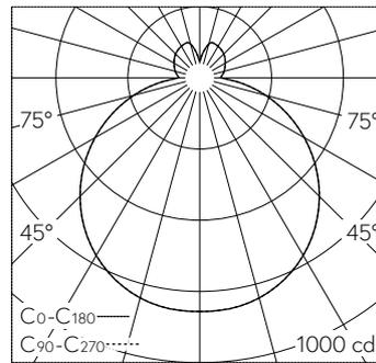
LED 3000 K 35 W 3343 lm-h / CIE Flux 42 73 91 81 100 / B32 nach DIN 5040
