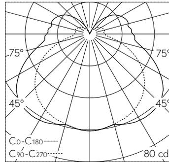
LED 4000 K 4.8 W 384 lm-h 148°/126° / CIE Flux 34 64 85 76 100 / B21 nach DIN 50...
