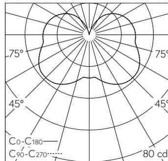
LED 3000 K 4.7 W 422 lm-h / CIE Flux 24 51 76 61 100 / B11 nach DIN 5040
