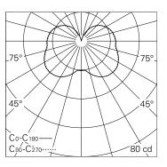
LED 3000 K 3.9 W 374 lm-h / CIE Flux 23 51 76 61 100 / B11 nach DIN 5040
