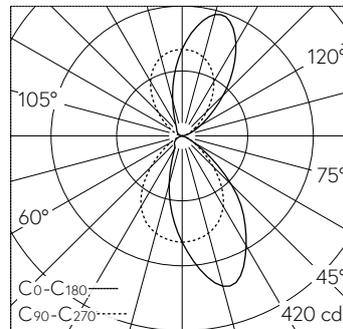
LED 4000 K 9.6 W 691 lm-h / CIE Flux 68 94 99 54 100 / C64 nach DIN 5040
