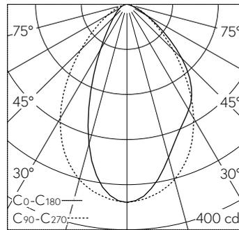
LED 4000 K 9 W 437 lm-h / CIE Flux 70 93 99 100 100 / A60 nach DIN 5040
