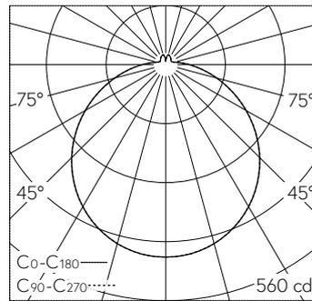
LED 2700 K 21.5 W 1588 lm-h / CIE Flux 43 73 90 91 100 / A31 nach DIN 5040
