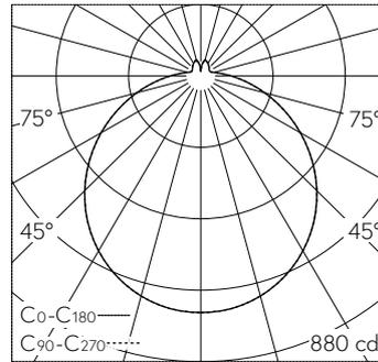
LED 3000 K 29.4 W 2598 lm-h / CIE Flux 43 72 90 89 100 / B32 nach DIN 5040
