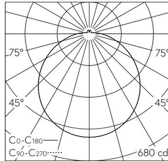
LED 3000 K 19.6 W 1890 lm-h / CIE Flux 43 73 91 93 100 / A31 nach DIN 5040
