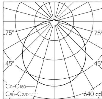
LED 2700 K 19.6 W 1827 lm-h / CIE Flux 43 73 91 93 100 / A31 nach DIN 5040
