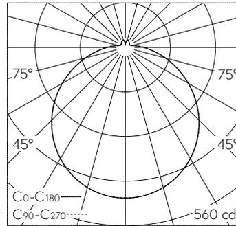
LED 3000 K 19.6 W 1645 lm-h / CIE Flux 43 73 90 91 100 / A31 nach DIN 5040
