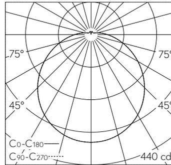
LED 3000 K 16.8 W 2306 lm-h / CIE Flux 42 71 89 91 100 / A31 nach DIN 5040
