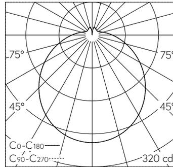
LED 3000 K 15.5 W 1024 lm-h / CIE Flux 41 69 88 86 100 / B31 nach DIN 5040
