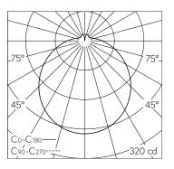
LED 2700 K 15.5 W 991 lm-h / CIE Flux 41 69 88 86 100 / B31 nach DIN 5040
