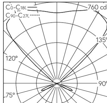
LED 2700 K 39 W 1919 lm-h / CIE Flux 5 34 99 13 100 / D14 nach DIN 5040
