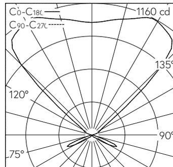
LED 4000 K 36 W 2886 lm-h / CIE Flux 5 34 99 13 100 / D14 nach DIN 5040
