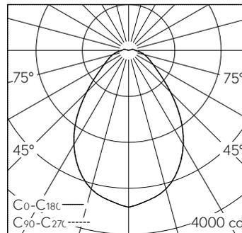
LED 3000 K 57 W 6714 lm-h / CIE Flux 59 83 94 96 100 / A50 nach DIN 5040
