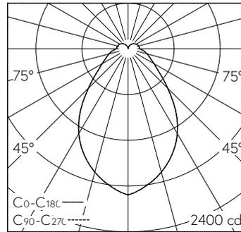
LED 4000 K 43 W 4492 lm-h / CIE Flux 55 79 91 84 100 / B51 nach DIN 5040
