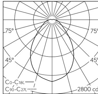
LED 4000 K 47 W 4589 lm-h / CIE Flux 59 83 94 96 100 / A50 nach DIN 5040
