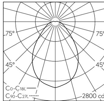
LED 4000 K 57 W 6076 lm-h / CIE Flux 59 83 94 96 100 / A50 nach DIN 5040
