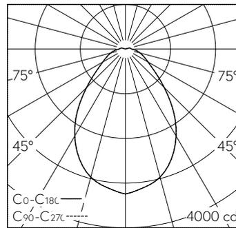
LED 4000 K 61 W 6076 lm-h / CIE Flux 59 83 94 96 100 / A50 nach DIN 5040
