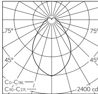
LED 3000 K 43 W 4271 lm-h / CIE Flux 55 79 91 84 100 / B51 nach DIN 5040
