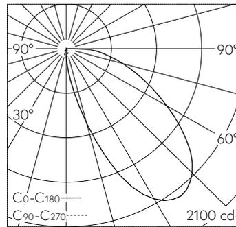
LED 2700 K 33.20 W 1332 lm-h / CIE Flux 37 73 92 100 100 / A30 nach DIN 5040
