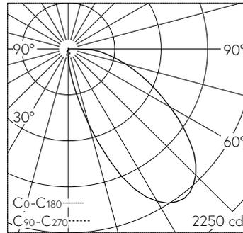
LED 2700 K 35.40 W 1403 lm-h / CIE Flux 37 73 92 100 100 / A30 nach DIN 5040
