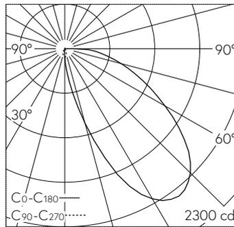
LED 3000 K 35.4 W 1459 lm-h / CIE Flux 37 73 92 100 100 / A30 nach DIN 5040
