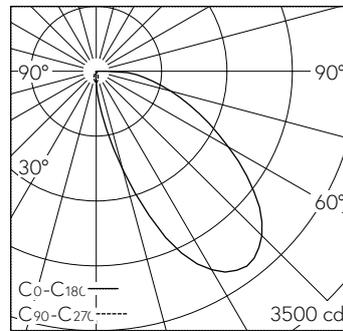
LED 2700 K 47 W 2015 lm-h / CIE Flux 37 73 92 100 100 / A30 nach DIN 5040
