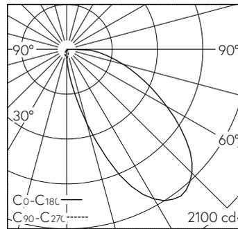
LED 3000 K 24,7 W 1317 lm-h / CIE Flux 37 73 92 100 100 / A30 nach DIN 5040
