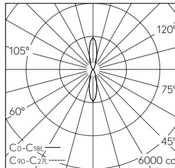
LED 2700 K 17,6 W 740 lm-h / CIE Flux 86 96 99 50 100 / C74 nach DIN 5040
