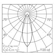
LED 2700 K 9,1 W 406 lm-h / CIE Flux 91 98 100 99 100 / A80 nach DIN 5040
