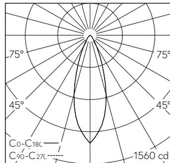
LED 2700 K 12,7 W 557 lm-h / CIE Flux 91 98 100 99 100 / A80 nach DIN 5040
