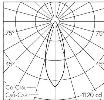
LED 4000 K 8,2 W 399 lm-h / CIE Flux 91 98 100 99 100 / A80 nach DIN 5040
