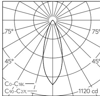
LED 2700 K 9,1 W 406 lm-h / CIE Flux 91 98 100 99 100 / A80 nach DIN 5040
