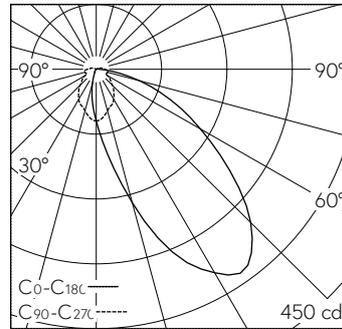
LED 8,9 W 372 lm-h / CIE Flux 45 80 95 97 100 / A40 nach DIN 5040
