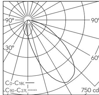
LED 2700 K 9,1 W 571 lm-h / CIE Flux 49 85 98 100 100 / A40 nach DIN 5040
