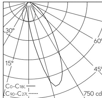
LED 4000 K 10,7 W 421 lm-h / CIE Flux 76 96 100 100 100 / A70 nach DIN 5040
