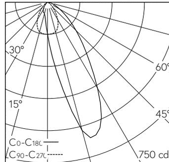
LED 3000 K 10,7 W 407 lm-h / CIE Flux 76 96 100 100 100 / A70 nach DIN 5040
