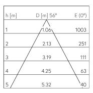
LED 4000 K 10,7 W 788 lm-h 56° / CIE Flux 95 100 100 100 100 / A80 nach DIN 5040
