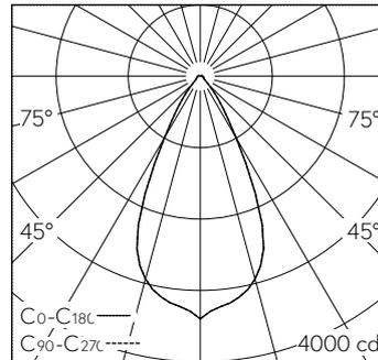
LED 4000 K 25 W 2711 lm-h / CIE Flux 88 95 98 97 100 / A81 nach DIN 5040
