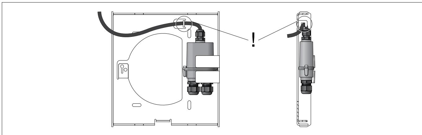
Leuchtengehäuse in die Montageplatte einsetzen und bis zum Anschlag in die vier Führungen einschieben.
