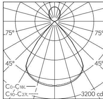
LED 4000 K 35 W 4923 lm-h / CIE Flux 94 100 100 73 100 / B83 selon DIN 5040
