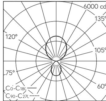
LED 5 x 4000 K 64 W 8565 lm-h / CIE Flux 69 91 98 28 100 / D63 selon DIN 5040
