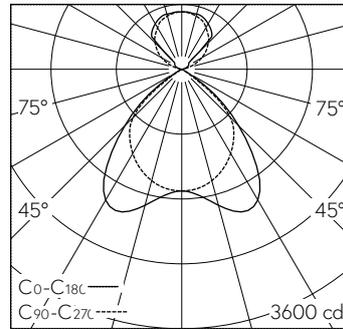
LED 4000 K 46 W 5417 lm-h / CIE Flux 71 99 100 68 100 / B64 selon DIN 5040
