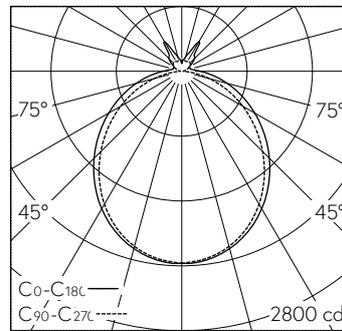
LED 4000 K 47 W 6287 lm-h / CIE Flux 47 77 93 87 100 / B43 selon DIN 5040
