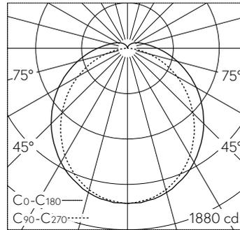
LED 4000 K 35 W 5542 lm-h / CIE Flux 44 74 91 92 100 / A41 selon DIN 5040
