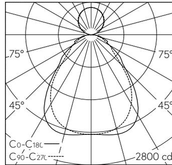
4 x LED 4000 K 48 W 6414 lm-h / CIE Flux 61 85 96 74 100 / B53 selon DIN 5040
